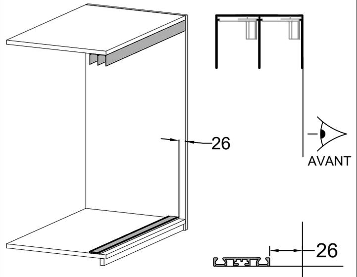
⚠ Contrôlez les positions des rails et doigts
