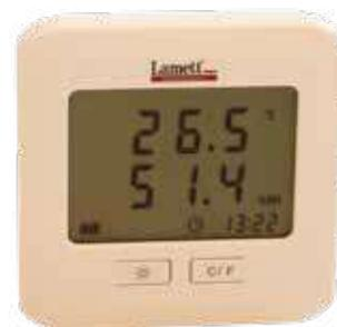
Une bonne humidité de l'air se situe entre 45% et 65%. Il est donc très important de poser le parquet lorsque l'hygrométrie se situe dans les normes, et après la pose, il est également important de surveiller ce pourcentage. Un pourcentage non adapté pourrait causer la rétraction ou encore la dilatation du parquet.
