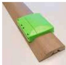
Les profilés sont posés à hauteur des embrasures de porte, des raccords avec d'autres revêtements de sol, des différences de niveau, des joints de construction et des joints de dilatation. Lors de la pose des profilés, un joint de dilatation de 10 mm doit également être prévu des deux côtés.
