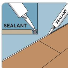
**ÉTAPE 2 :** Comblez l'écart de dilatation avec le **scellant HydroPlus Sealant**. Le mastic doit toucher le mur et le sol stratifié de telle manière que lorsqu'il est appliqué, il comble complètement le joint.
