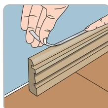
**ÉTAPE 3 :** Appliquez une **bande de protection HydroPlus Strip** à la base de la plinthe à l'aide d'une bande adhésive. Cette bande protège votre plinthe de l'humidité, tout en permettant au sol stratifié de se dilater/rétracter.
