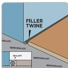
**ÉTAPE 1 :** Utilisez le **Fillertwine BerryAlloc** dans le joint de dilatation. La pâte de garnissage fillertwine permet au sol stratifié de se dilater/rétracter. À utiliser également dans l'écart de dilatation sous les profils de sol comme les barres de jonction, les barres de seuil...
