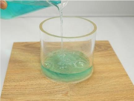
**Test 1** : Il s'agit d'un test avec un cylindre (Nalpa surface water test) qui est fixé sur l'intersection de 3 lames de stratifié. Le cylindre est rempli d'eau teintée et est laissé en place pendant 24h pour voir si l'eau pénètre dans les joints.
