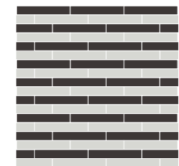
Pont de bateau Lames A, flottant
