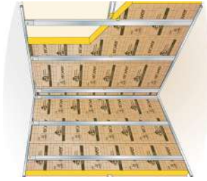
3 POSE DES FOURRURES VERTICALES
