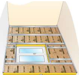
5 LISSES CLIP'OPTIMA ET FOURRURES EN ARÊTE D'ALLÈGE ET D'IMPOSTE
