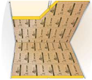
2 POSE DE L'ISOLANT
